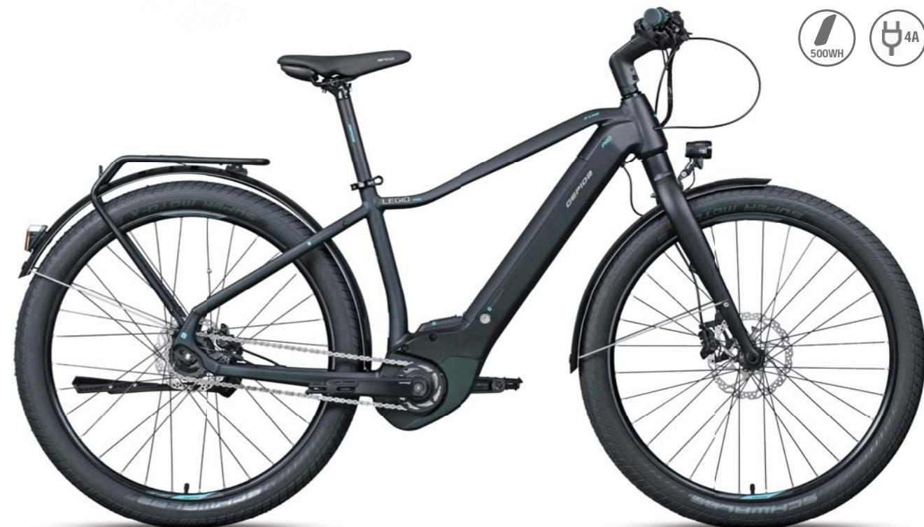
△ FRAME GEPIDA GRAVITY CASTING - 6061 ALLOY
